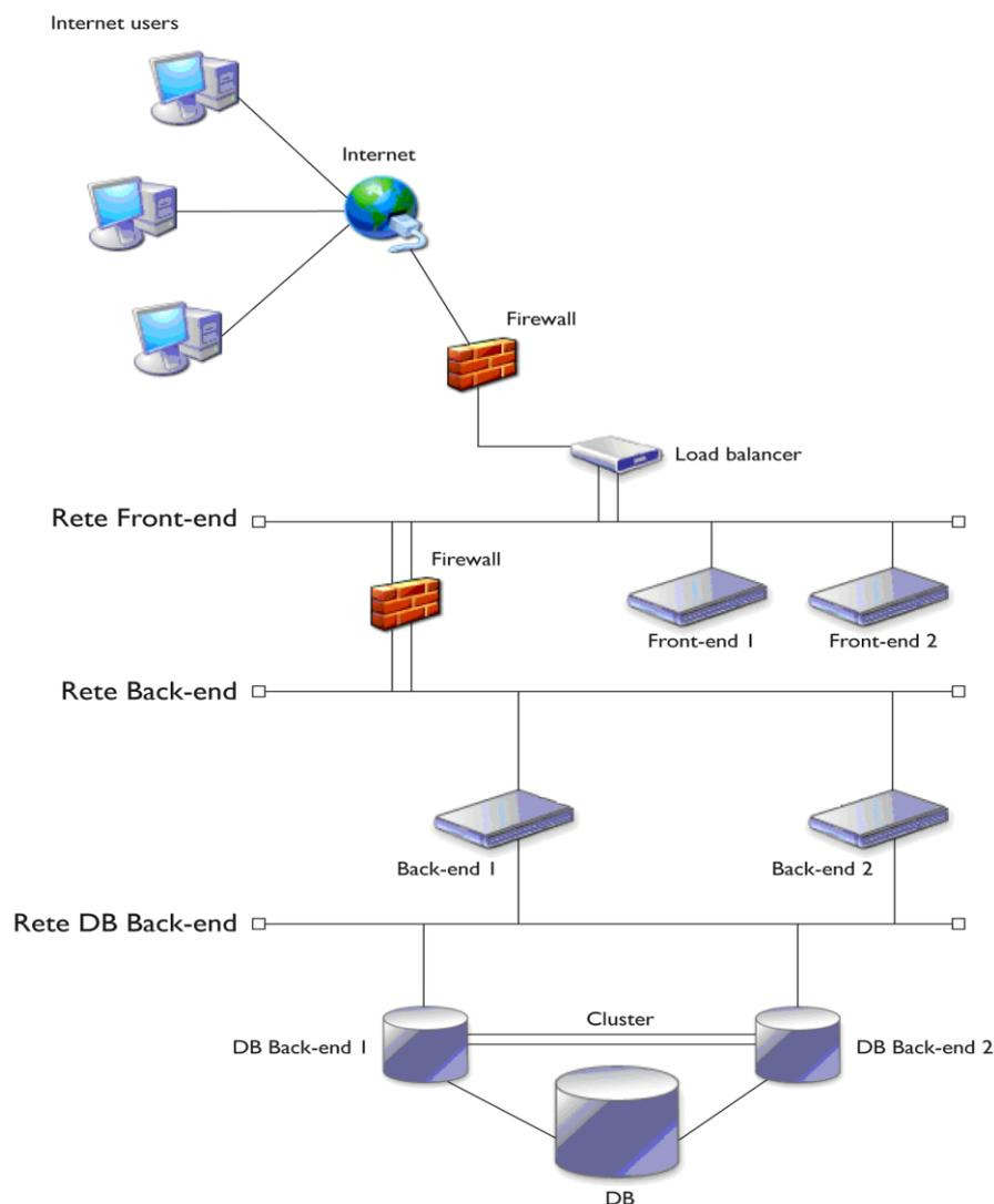
La soluzione proposta prevede un firewall, collegato direttamente ai *Core Router* internet, che protegge la rete di Front-End da accessi indesiderati. A sua volta il Firewall è collegato al Load Balancer (Bilanciatore di Carico) che funge da livello di astrazione fra Internet e i server di Front-end. Gli utenti accedono ad un indirizzo IP Virtuale (VIP) attestato sul bilanciatore, il quale smista tutte le richieste verso i server di Front-End.
